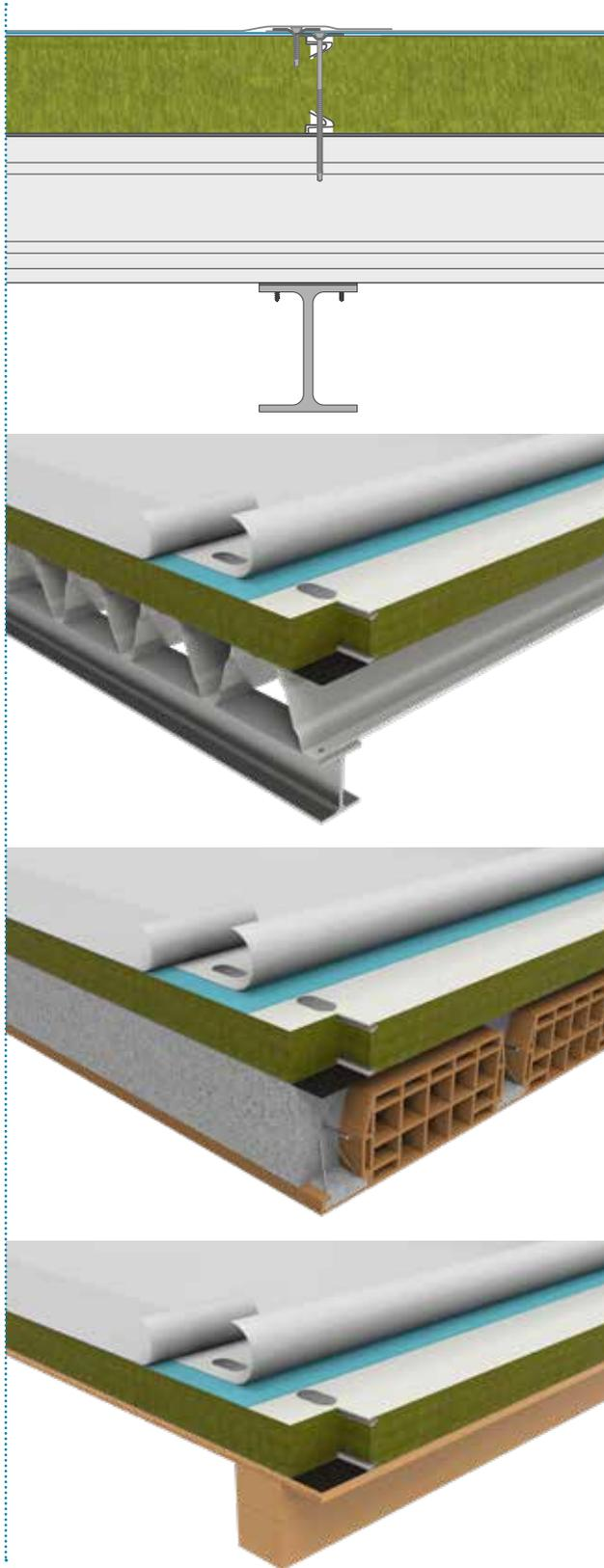
ISOFIRE WALL FLAT SYSTEM può essere impiegato per la composizione del sistema ISODECK LG, utilizzando le lamiere grecate Isopan:
